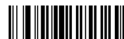
禁止上传成功蜂鸣 (备注：扫描枪扫此条码成功时，上传数据会“滴”一声)
